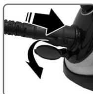
1.3 Abrir la tapa de la toma monobloque; introducir el enchufe monobloque hasta que se oiga el clic del enganche. Asegurarse de que esté bien acoplado antes de continuar. Para desconectar el tubo flexible, presionar el botón de desenganche y simultáneamente extraer el enchufe monobloque
