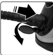
1.3 Soulever la protection de la prise monobloc et brancher la fiche monobloc jusqu'à ce qu'il y ait un dé clic. Contrôler si la fiche est bien branchée avant de procéder. Pour décrocher la gaine, il suffit d'appuyer sur la touche correspondante tout en enlevant la fiche monobloc.
