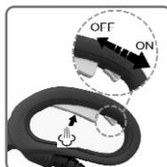
1.4 La pistola vaporizadora del tubo flexible está dotada de un botón de seguridad que impide la activación accidental del suministro de vapor por parte de niños o personas que no conozcan el funcionamiento del aparato. Para impedir la salida accidental de vapor, llevar la tecla a la posición OFF. Para volver a vaporizar, llevar la tecla a la posición ON.
